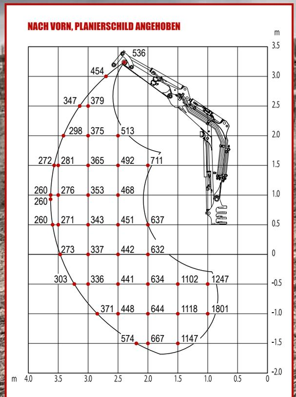
Die Hublasten in den Grafiken betragen bis zu 87% der hydraulischen Hublast bzw. bis zu 75% der Kipplast.
